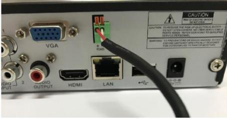
O módulo PGM TWG deve ser ligado a uma fonte de alimentação 12V 1A.
