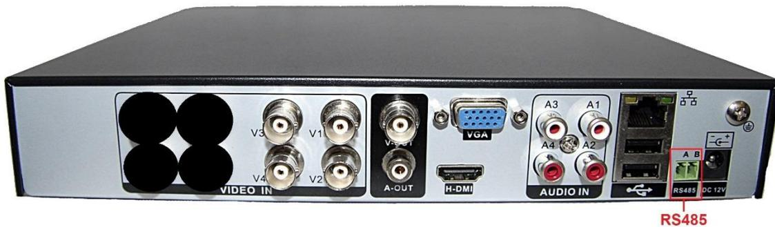
1、 Conecte os cabos de comunicação RS485 da Speed Dome na interface RS485 do DVR TWG (A=RX+ / B=RX- ).
