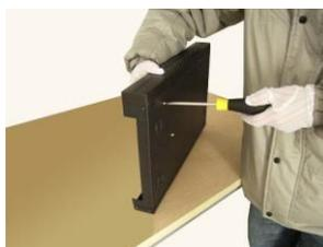
④ Fixe os parafusos do HDD
