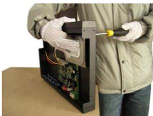
③ Alinhe os furos dos parafusos do HD com os furos da carcaça do IDVR
